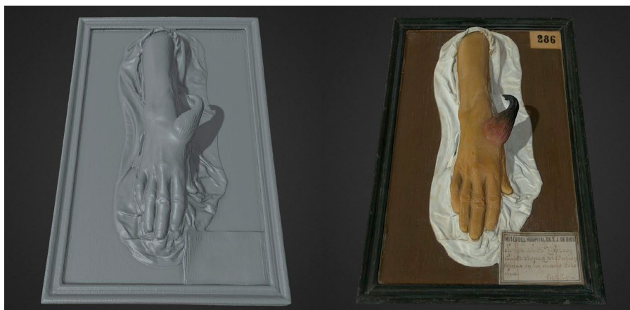
Figura 12. Modelo digitalizado utilizando un escáner de luz estructurada Artec Eva: malla 3D sin textura de color (izquierda); mismo modelo con textura aplicada (derecha)
