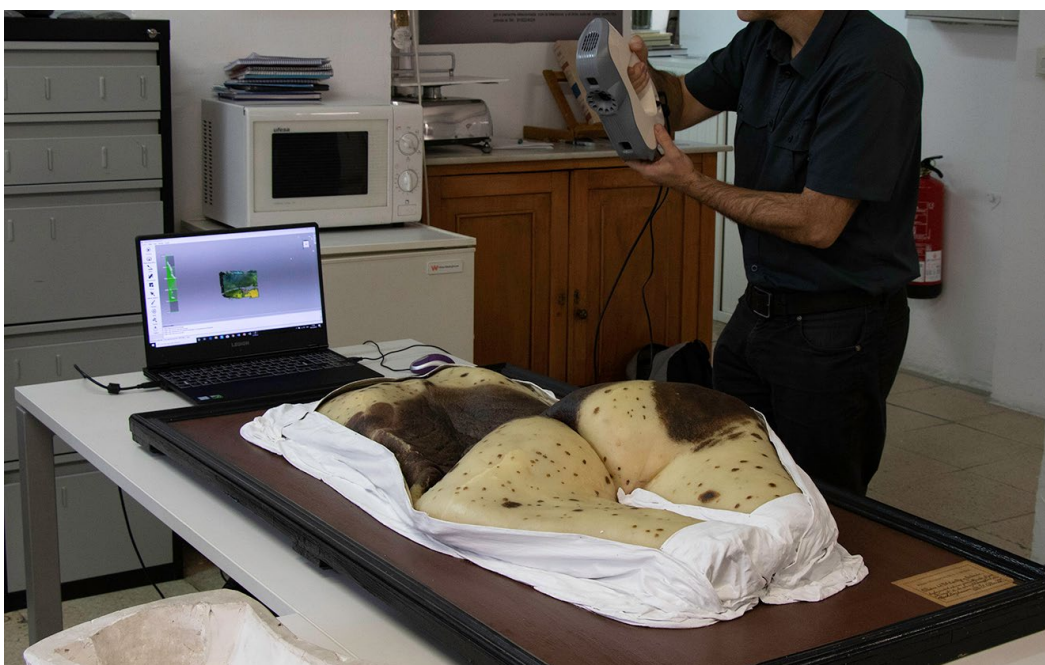
Figura 5. Fase de registro empleando un escáner de luz estructurada Artec Eva
